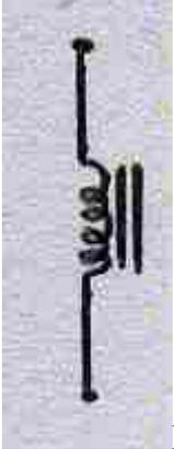
**BOBINA (INDUTOR) COM NÚCLEO DE FERRO**
